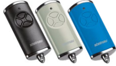
Micro-Handsender HSE 4 S3 · 4 Tastenfunktionen · Mit Schlüsselring · Serienmäßig in Schwarz (beim Antrieb P 80 und P 90) · Optional erhältlich in den Farben „Papyrus weiß“ oder „blau“
